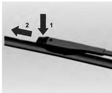
Levante a alavanca do limpador. Pressione a aba de travamento (seta 1) e puxe a palheta para removê-la (seta 2).
