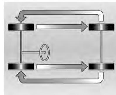
Forças diferentes nos pneus dianteiros e traseiros fazem com que eles se desgastem de forma diferente, dependendo de vários fatores, como a superfície da pista, a forma de condução, o alinhamento da suspensão, o balanceamento das rodas, a pressão dos pneus etc.
