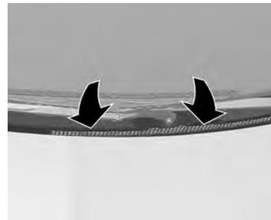
A entrada de ar em frente ao para-brisa no compartimento do motor deve estar desobstruída para permitir a entrada do ar. Remova folhas e sujeira.
