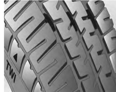
Os pneus também deverão ser substituídos quando a profundidade da banda de rodagem estiver desgastada até próximo do indicador de desgaste do pneu. A imagem mostra onde a profundidade da banda de rodagem pode ser encontrada.
