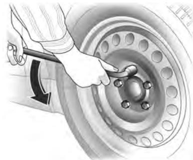
Instale a chave de roda assegurando-se de que ela esteja assentada de forma segura e afrouxe cada parafuso meia volta.
