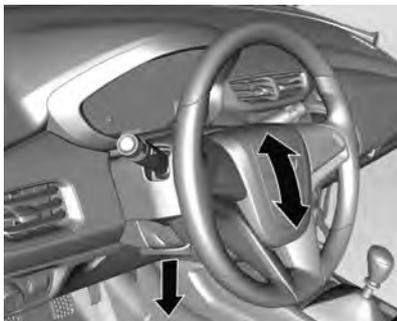
Destrave a alavanca, regule a altura do volante e depois trave a alavanca. Certifique-se de que esteja totalmente travada.
