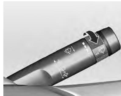
Com a alavanca do limpador na posição
