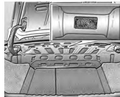
Automaticamente acende ou apaga gradativamente as luzes quando as portas e/ou o porta-malas são abertos, a chave é removida da ignição ou após um comando remoto de destravamento das portas.
