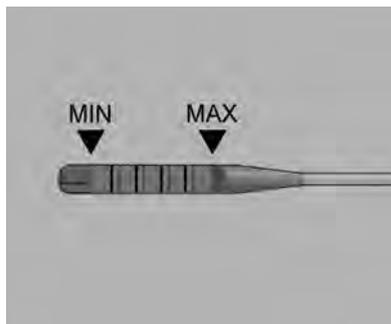
Limpe-a bem, introduza até o fim e torne a retirar. O nível do óleo tem de estar entre as posições inferior (MIN) e superior (MAX) da vareta.
