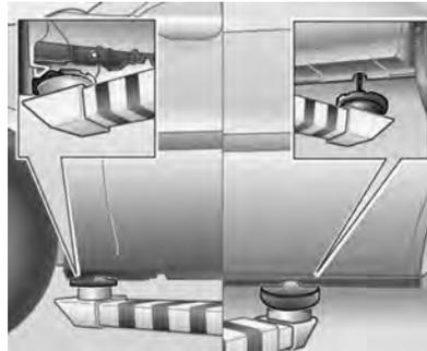
O local dos pontos de apoio de um elevador ou macaco tem de ser aplicado somente nos locais indicados nas figuras, nas porções dianteira e traseira, nas áreas entre o local para instalação do macaco e as caixas das rodas.
