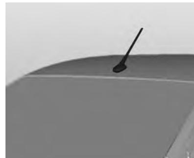
Para remover a antena do teto, gire-a no sentido anti-horário. Para instalar a antena do teto, gire-a no sentido horário.
