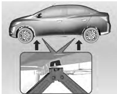
3. Ajuste o macaco até a altura necessária. Posicione-o diretamente sob o ponto de levantamento para evitar que escorregue.
