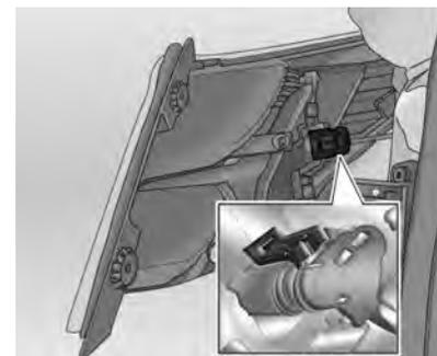
3. Remova a trava do conector e remova-o do conjunto da lanterna traseira.
